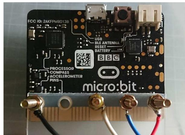
取り付けたところ。表面のビスが他の端子に接触しないように注意。
